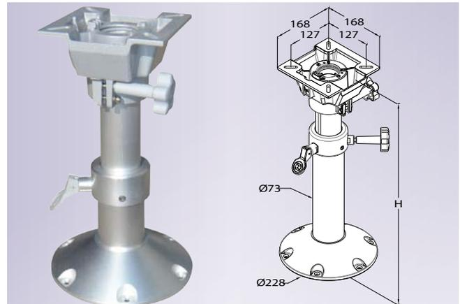
Mechanisch verstellbares **Stuhlbein**. Gefertigt aus hochwertigem Aluminium und ausgestattet mit einem Drehkopf. Sieben Einrastpunkte im 25 mm Abstand.
