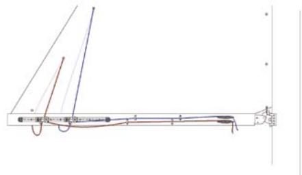
Bestehend aus Aluminiumschiene komplett mit Endstücken und Edelstahlrutschern mit Federfeststellern.
